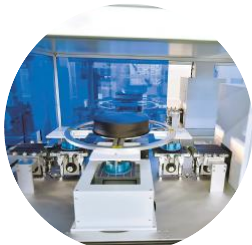
通威太阳能(成都)有限公司 S2 车间分选工序正在根据外观信息对电池片进行自动分选
