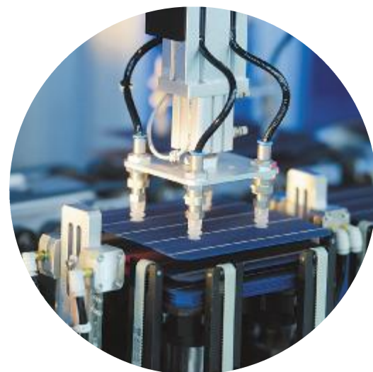
通威太阳能(成都)有限公司 S2 车间分选工序机械手正在根据电性能、EL 信息、外观信息对电池片进行自动分选
