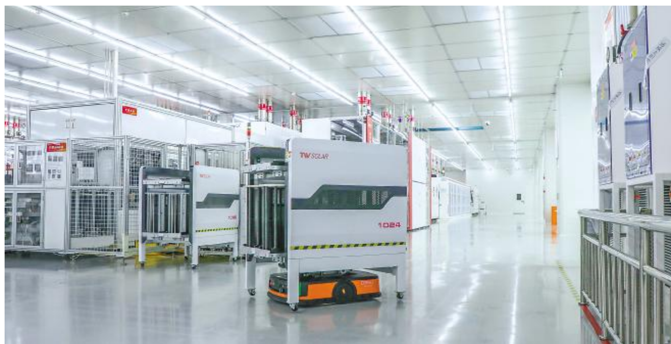
通威太阳能智能制造车间IGV小车
